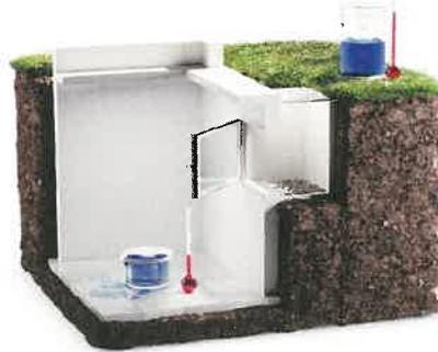
Warme Außenluft von 32°C enthält bei 50% r.F. 15,0 g Wasser je kg Luft
